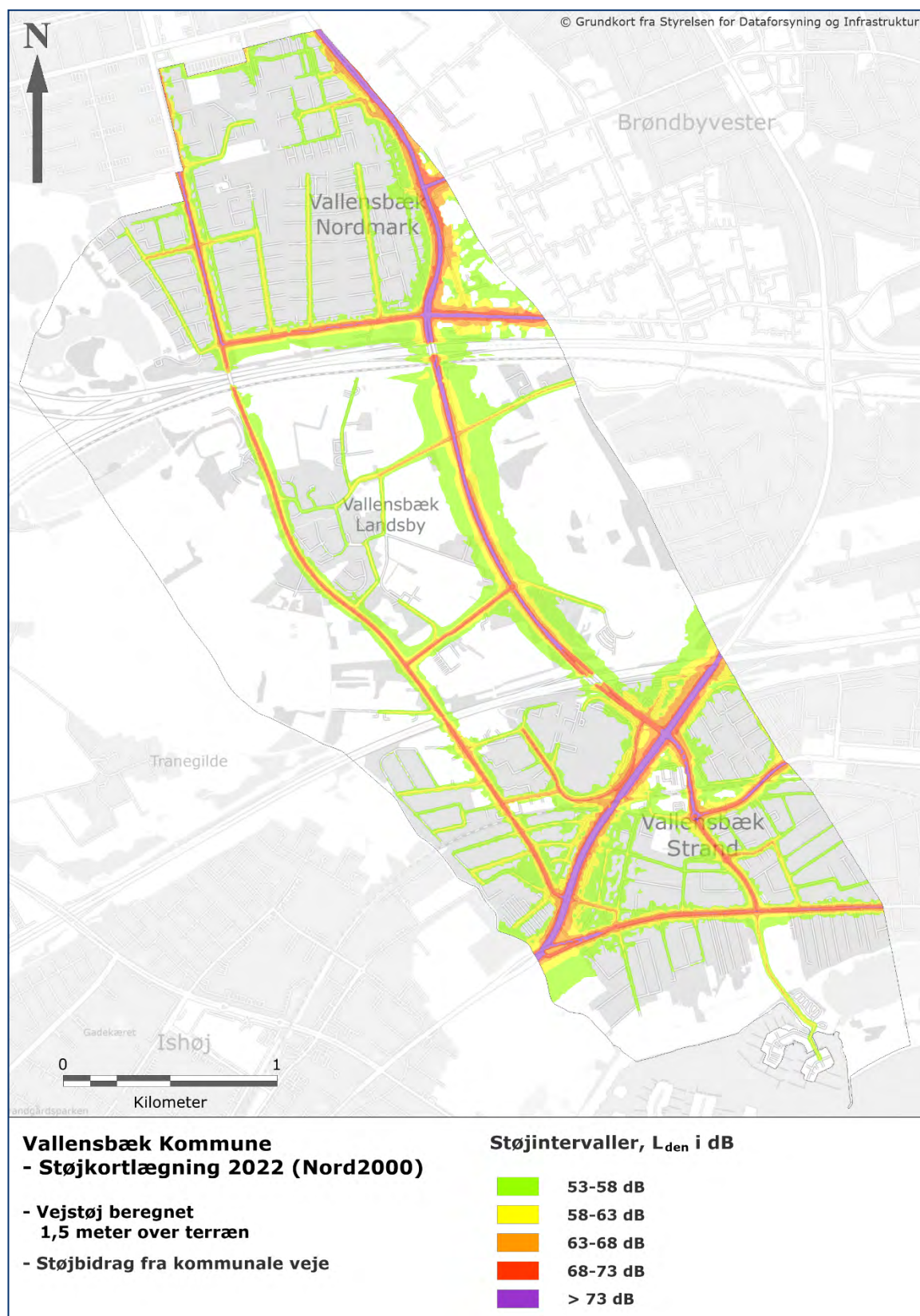
Figur 7. Kort over den del af trafikstøj, der skyldes kommunens egne veje i 2022. Kortet viser niveauer for støjbelastningen ( L_{den} i dB) med farvesignaturer i 5 dB spring. Støjen er vist i højde 1,5 meter over terræn. Der indgår også støj fra kommunale veje i tilstødende kommuner, men ingen støj fra statens veje.
